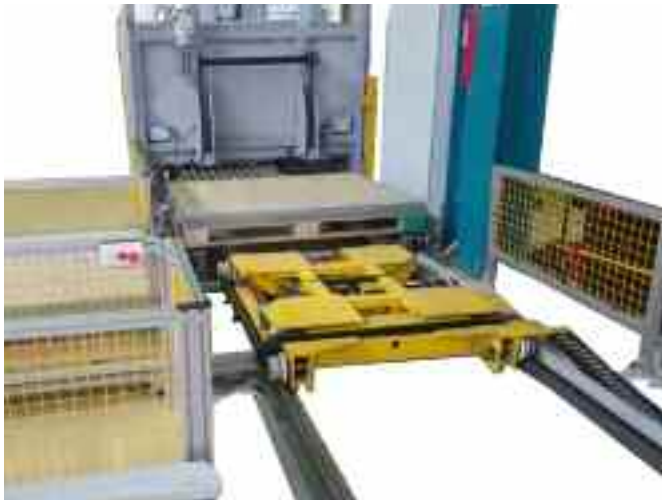
Sistem automat de transfer pentru transport nefaburi
