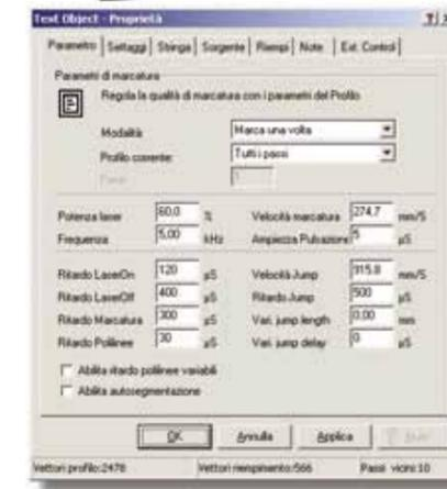
Gestione completa dei parametri di marcatura (velocità, potenza, frequenza etc).
